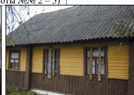
Здание Горковской базовой школы с двумя пристройками (инв. № 01010001) -кирпичное с дощатыми пристройками, 1960 г.п., 1 этаж, общ. S – 372,1 кв.м, перекрытия – плита ж/б, крыша – шифер. Пристройка к зданию Горковской базовой школы (инв. № 01081828) – кирпичная, 1993 г.п., S – 6,5 кв.м. крыша – шифер. Пристройка к зданию Горковской базовой школы (инв. № 01081829) — дощатая, 1993 г.п., S – 6,1 кв.м, крыша – шифер. Калитки деревянные (инв. №№ 01140154, 01140155). Покрытие бетонное
